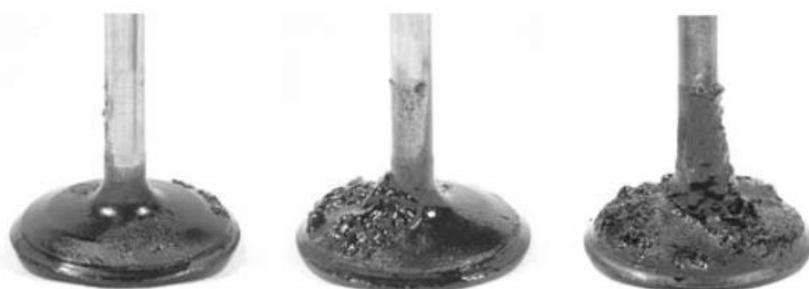
Figura 3 – Formação de depósitos nas válvulas de admissão vs concentração de aditivo de contra a formação de depósito [5]. Concentração de aditivo: Elevada (esquerda); Baixa (meio); Inexistente (Direita)
